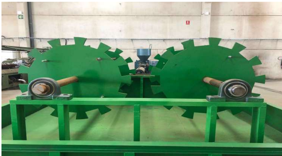
Ilustración 3: Revólveres donde se soportan los distintos moldes en el proceso de extrusión para la obtención de perfiles y postes de madera plástica Solteco
