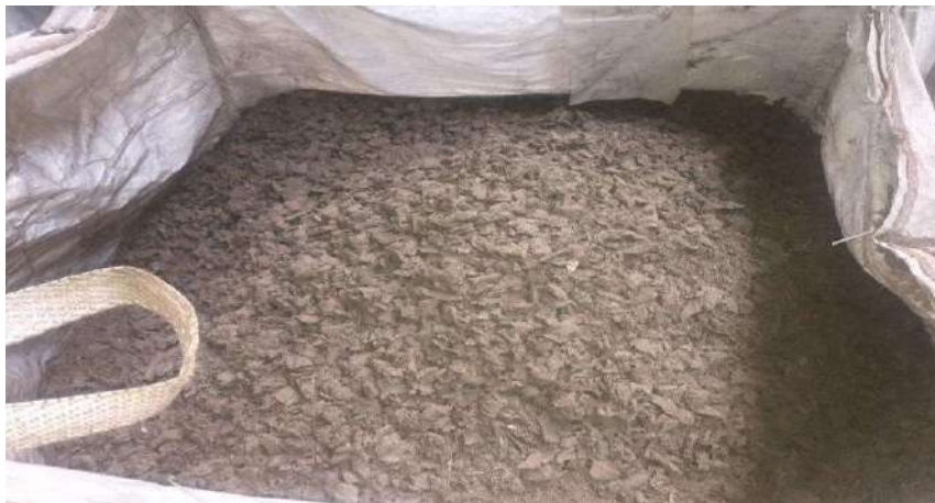
Ilustración 7: Pre-mezcla o masa polimérica para la elaboración del perfil símil madera plástica.
