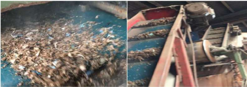
Ilustración 5: Fase de pretratamiento en fábrica, triturado y generado de escama plástica.
